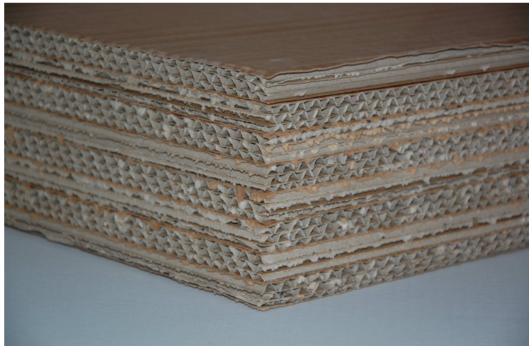
Abb.11: Struktur eines Z+B ÖkoZellstoffelementes Quelle: Verbundelement KG i.G.
