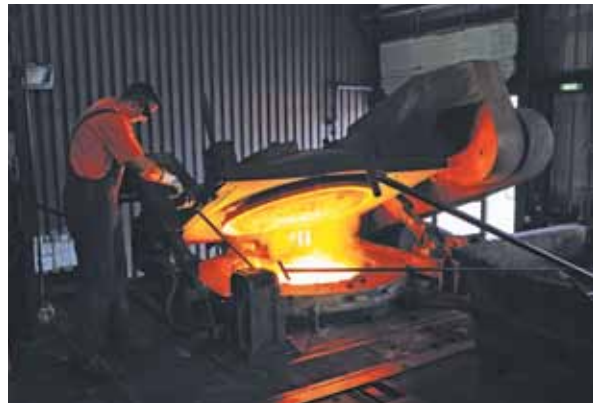
Ortrander Eisenhütte: Induktionsschmelzofen mit moderner Staubabsaugung
