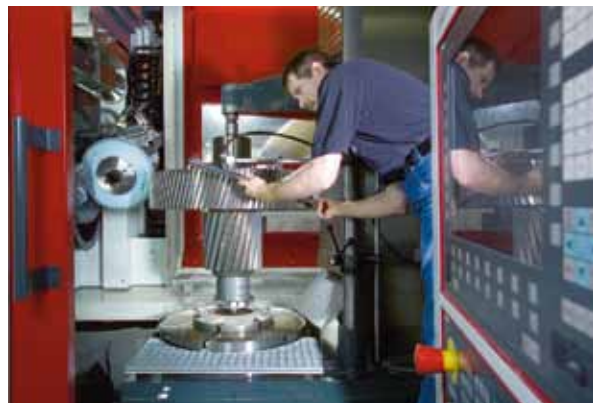
Endbearbeitung von Zahnrädern für Windradgetriebe auf modernsten Zahnflankenschleifmaschinen, Zahnradwerk Pritzwalk GmbH in Pritzwalk
